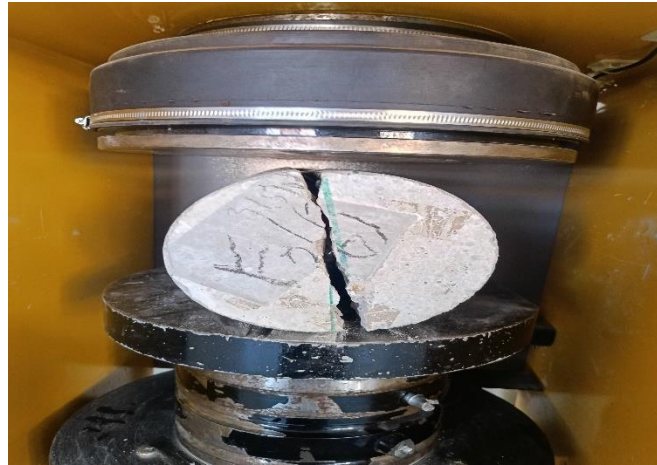
Figure II.34 : la mise en œuvre de traction par fendage sur une éprouvette cylindrique
