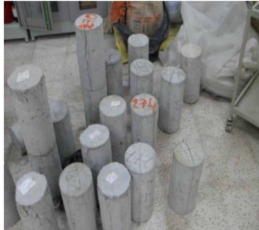
Figure II.30 : les échantillons cylindriques de dimensions ( \varnothing 16 \times 32 cm) du béton fibré
