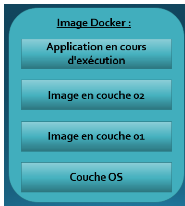
FIGURE 2.2 – Image Créée en Utilisant Dockerfile [ Basé sur [35] ]
