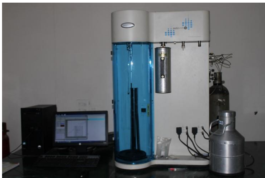
Figure II.5. L'appareils de mesure de la surface spécifique par la méthode de BET
