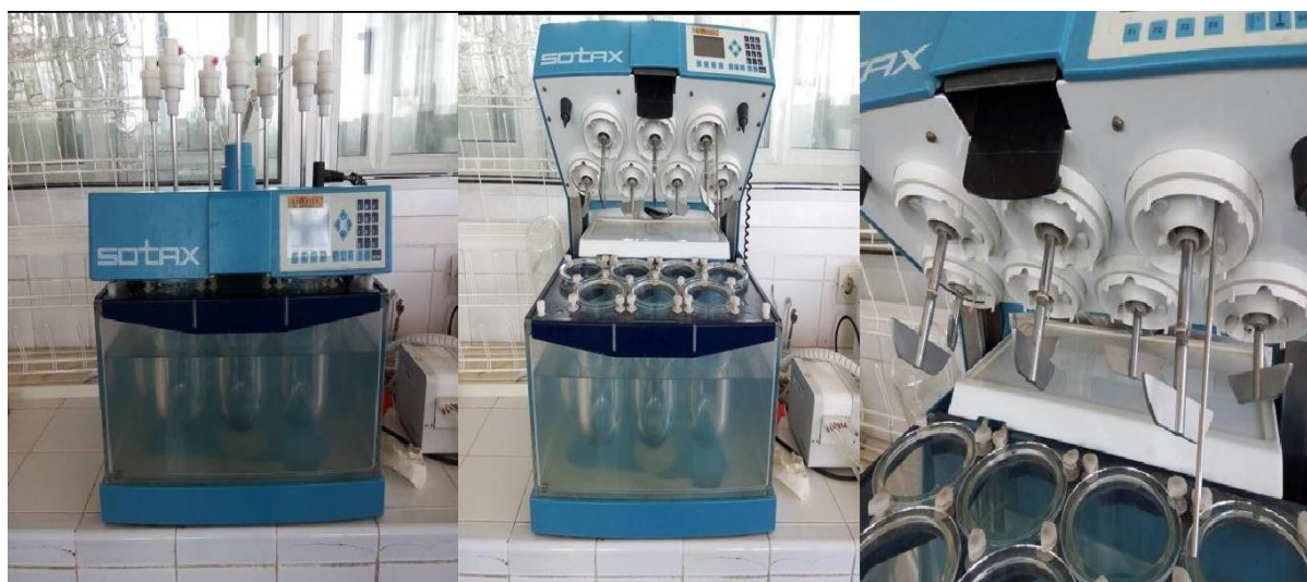
Figure III.2 : Dissolu-test à palette tournante (Original).
