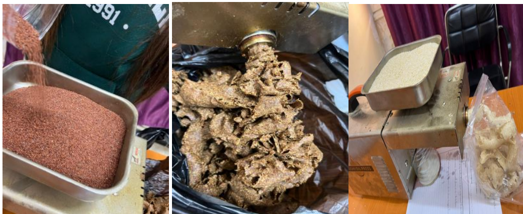
Figure 10 : Les étapes de l'extraction des huiles (Originale, 2025).
