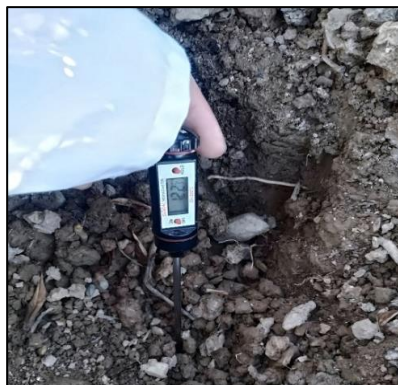
Mesure de température du sol
