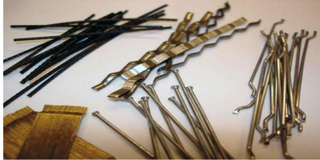
**Figure II. 5 :** Différentes forme de fibres métalliques [11]
