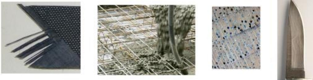
**Figure II. 2:** Exemples de multi-matériaux : (a) un composite carbone/époxy, (b) un béton armé, (c) du bois vu au microscope optique, (d) une lame d'acier de Damas (image de Ralf Pfeifer). [10]
