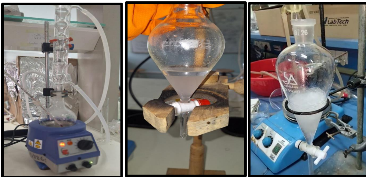
Figure III-1 : Photos du montage de la synthèse, la séparation et du lavage de l'ester.
