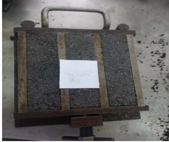
Figure III.9. Mortier après les secousses.
