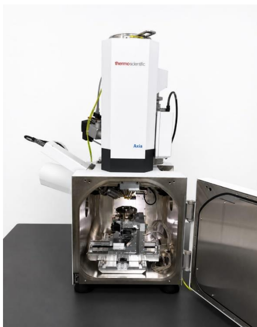
Figure II.5. Appareil Thermo Scientific Axia utilisé pour l'analyse XPS des surfaces.
