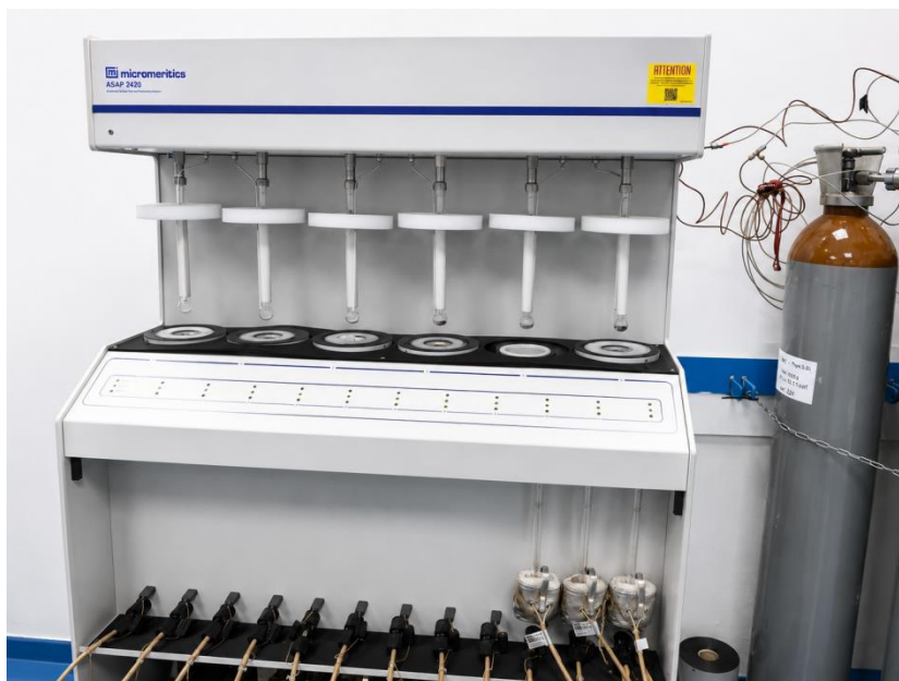
Figure II.4. Dispositif d'évaluation de la surface spécifique et la porosité BET (Micromeritics ASAP 2420).
