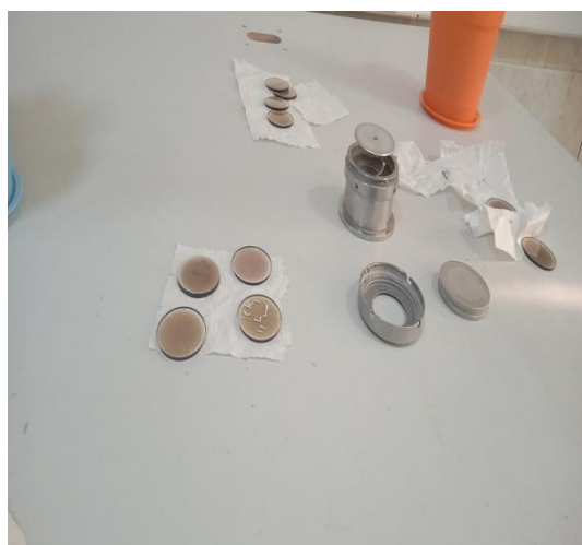
(c) Pastilles d'échantillons prêtes pour XRF échantillons de sol sous forme de tableau
