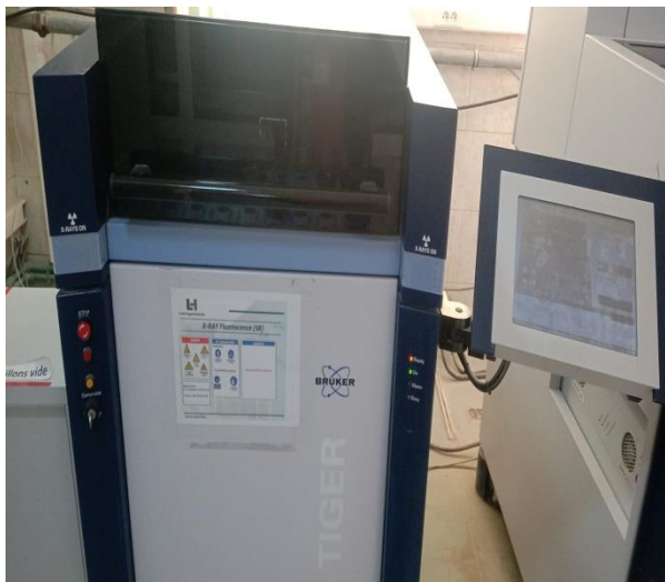
(b) Spectromètre à fluorescence X (XRF)
