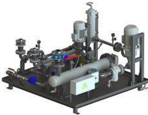
Figure II.12 : Unité de refroidissement huile/eau du réducteur SYMETRO
