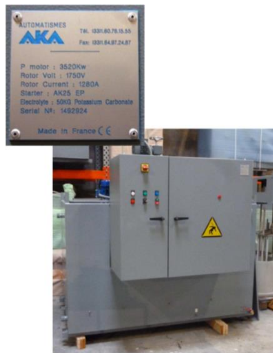
Figure II.1 : Vue d'ensemble du démarreur liquide à électrodes AK-EP
