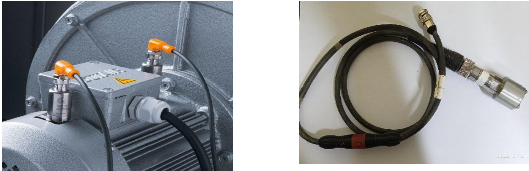
Figure IV.2 : Chaîne de mesure vibratoire avec le VB8 et l'accéléromètre
