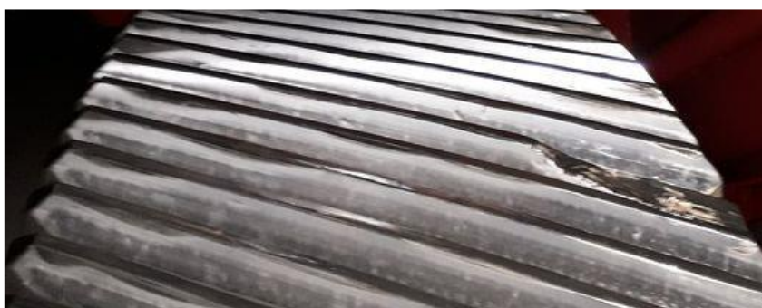
Figure IV.16 : Photo du volant d'équilibrage (côté bague de guidage/broyeur) – dents endommagées
