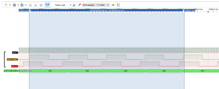
Figure III.6 — Validation en boucle fermée à l'analyseur logique ( K_P = 13 , K_I = 24 )
