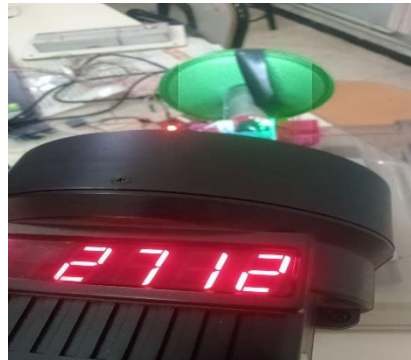
Figure IV.11 — Mesure stroboscopique de la vitesse réelle (consigne = 5 imp./10 ms)
