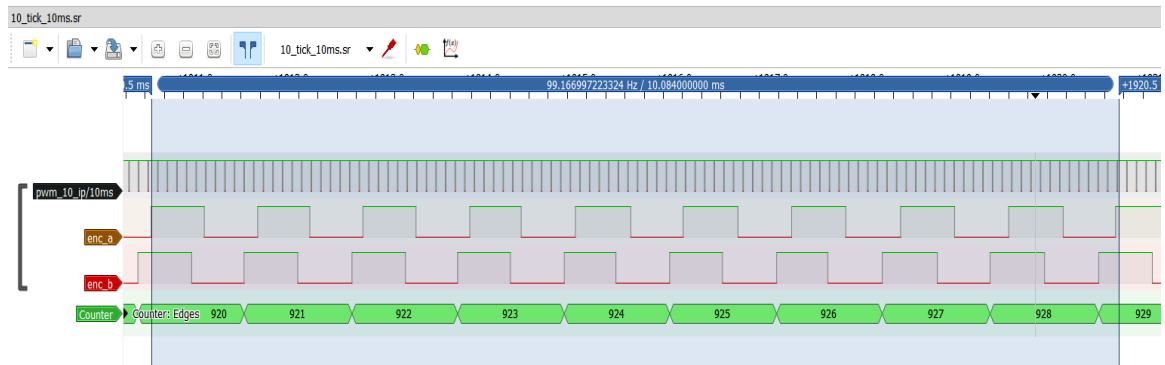
Figure IV.4 — Comptage de 10 impulsions par fenêtre de 10 ms
