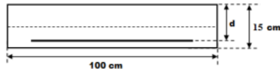
Figure IV-3: La coupe utilisée pour calculer le ferrailage d'acrotère
