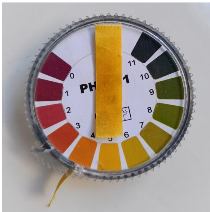
Figure III- 1 : Mesure de pH de l'HE de Pistacia lentiscus L.
