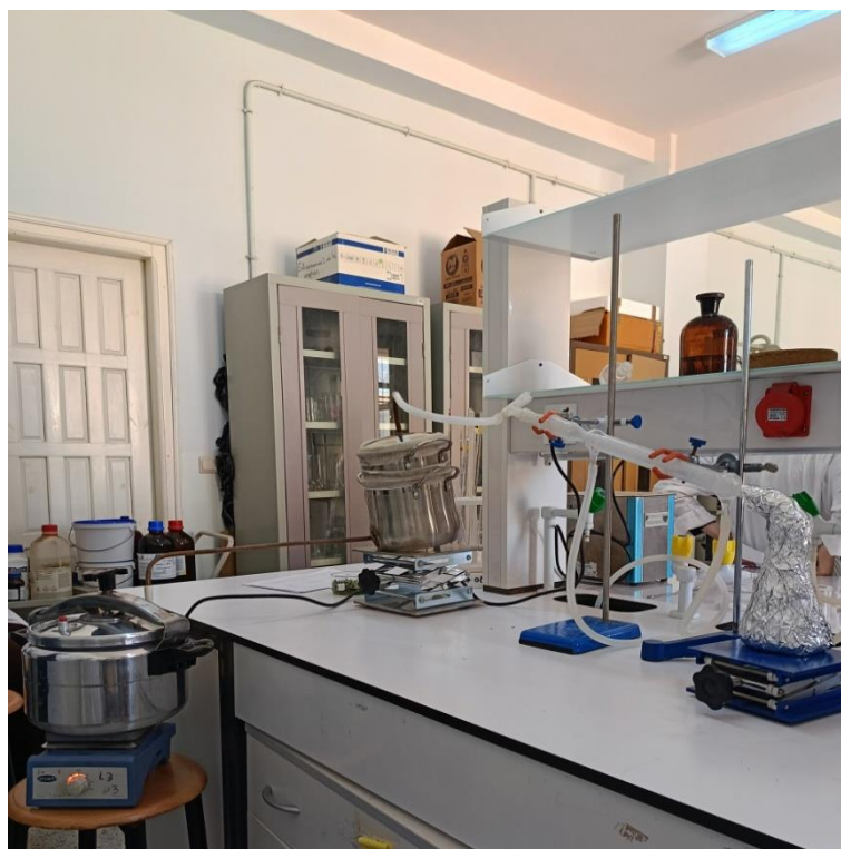
Figure II- 3: Montage expérimental d'entraînement à la vapeur d'eau.
