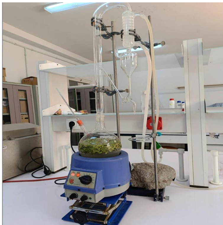
Figure II- 2: Montage expérimental d'hydrodistillation.
