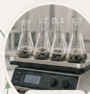
Expériences d'adsorption (agitation contrôlée)
