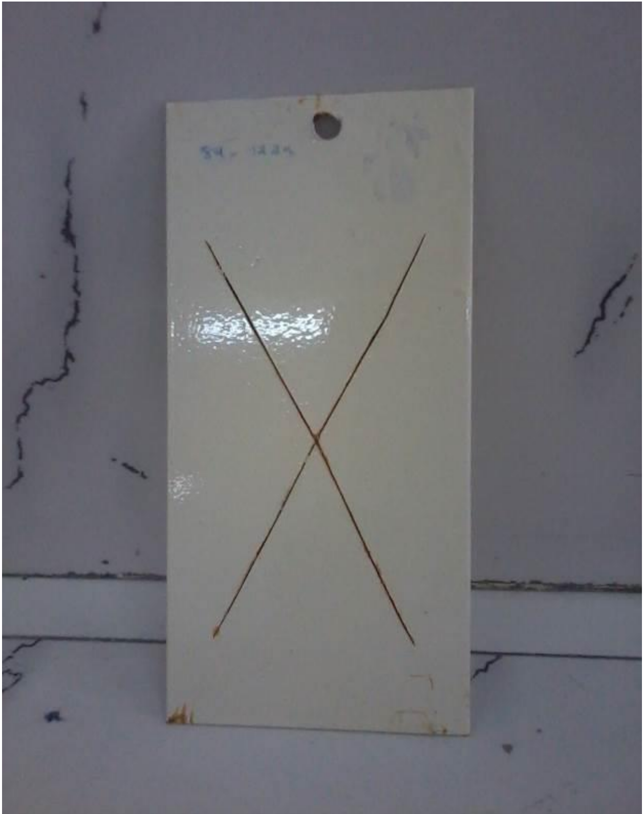
Figure IV. 18 : Test brouillard salin, système de peinture standard, durée d'exposition 10 jours.
