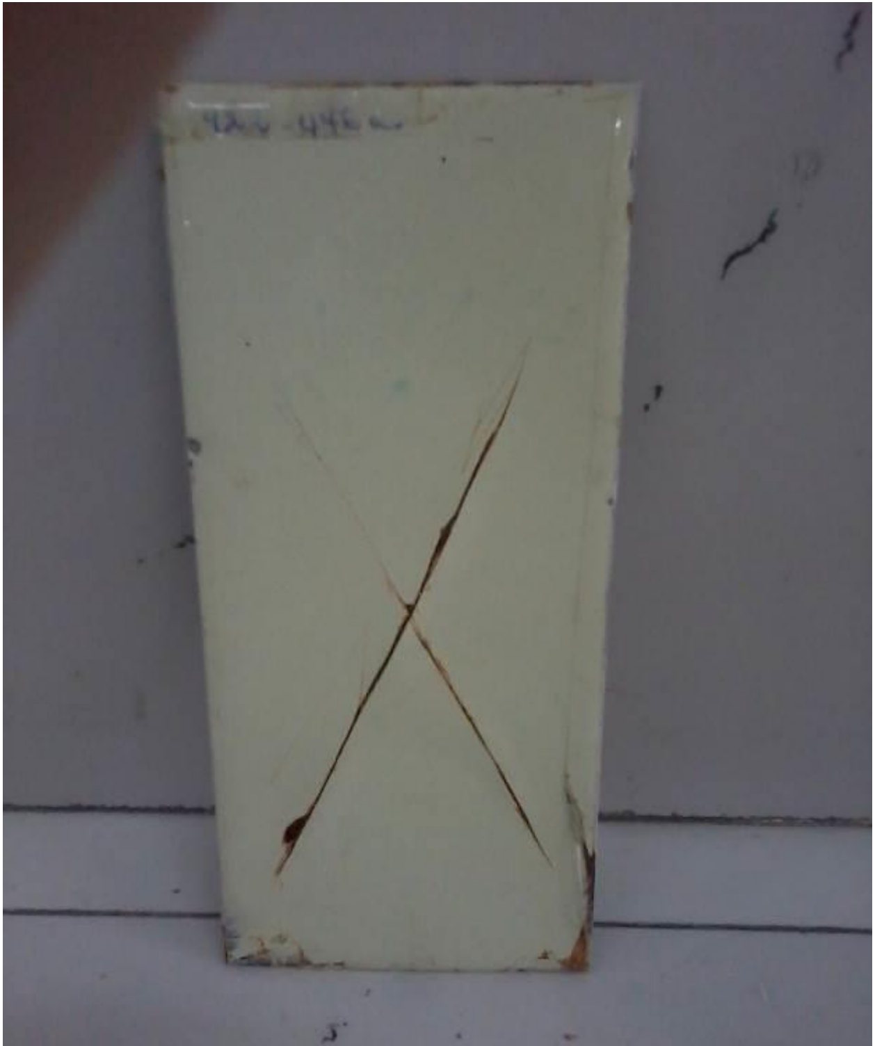
Figure IV. 23 : Test brouillard salin, système de peinture monocouche modifié, épaisseur film sec 200 \mu\text{m} , durée d'exposition 20 jours.
