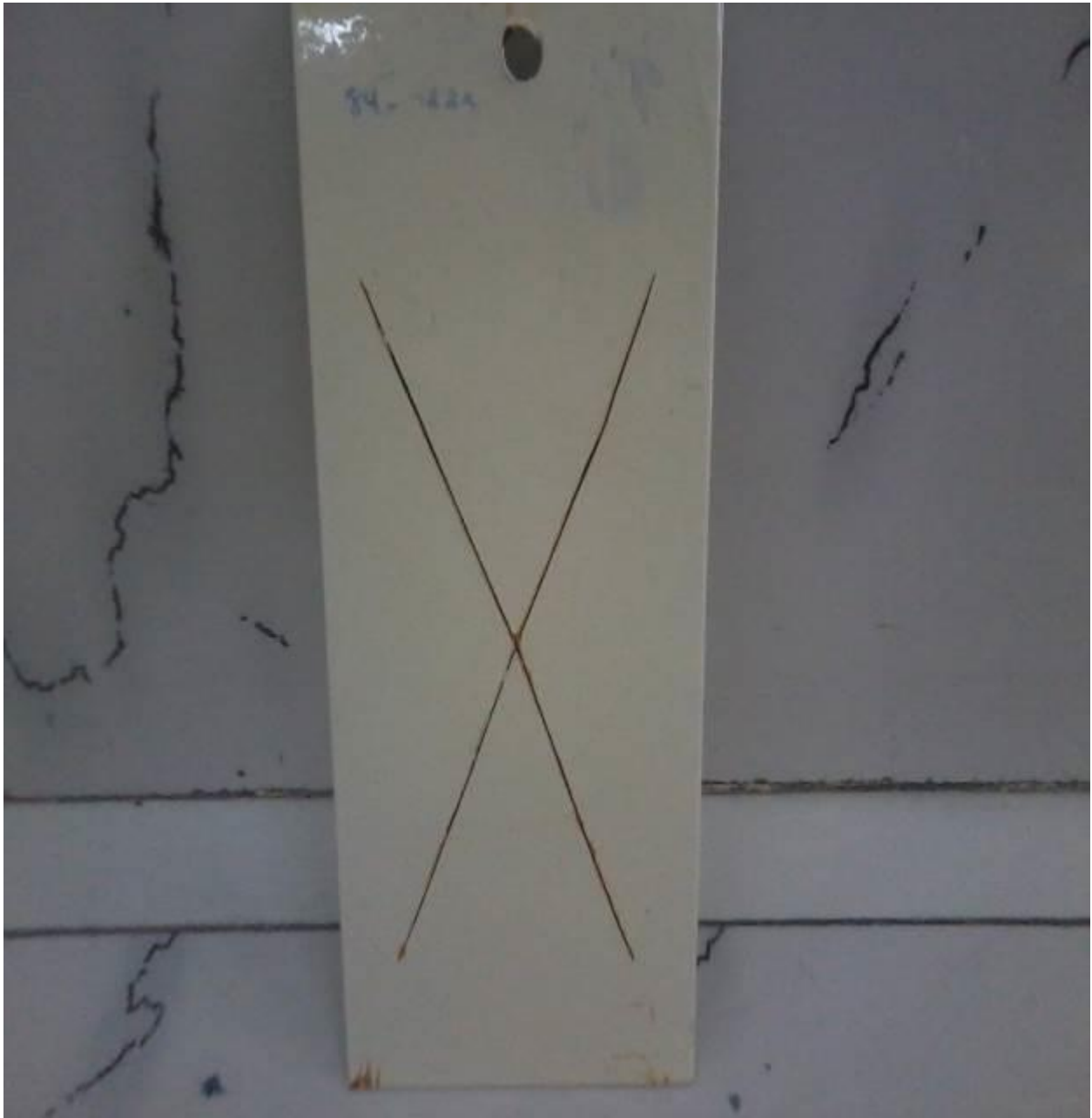
Figure IV. 21 : Test brouillard salin, système de peinture standard, durée d'exposition 20 jours.
