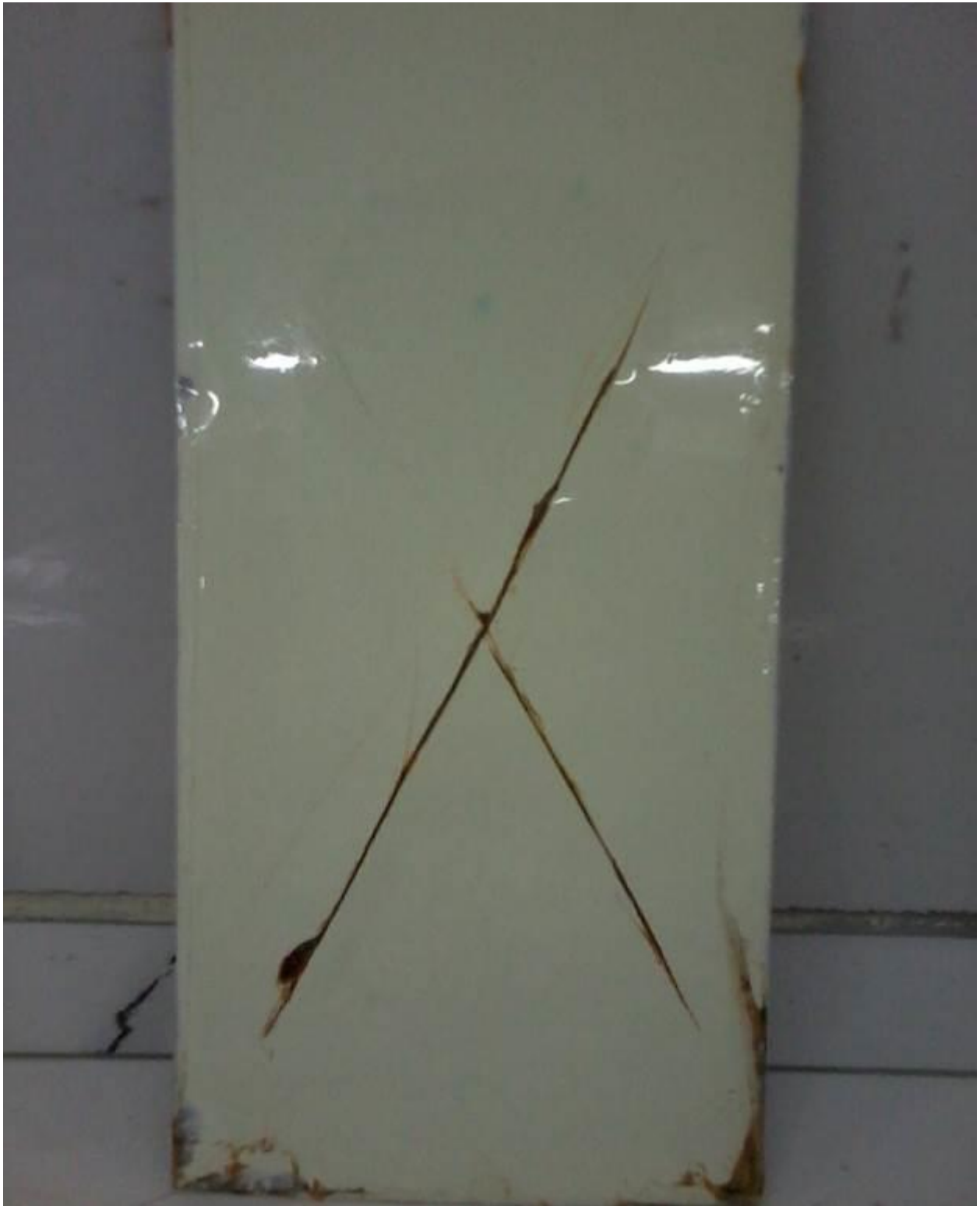
Figure IV. 20 : Test brouillard salin, système de peinture monocouche modifié, épaisseur film sec 200 \mu\text{m} , durée d'exposition 10 jours.
