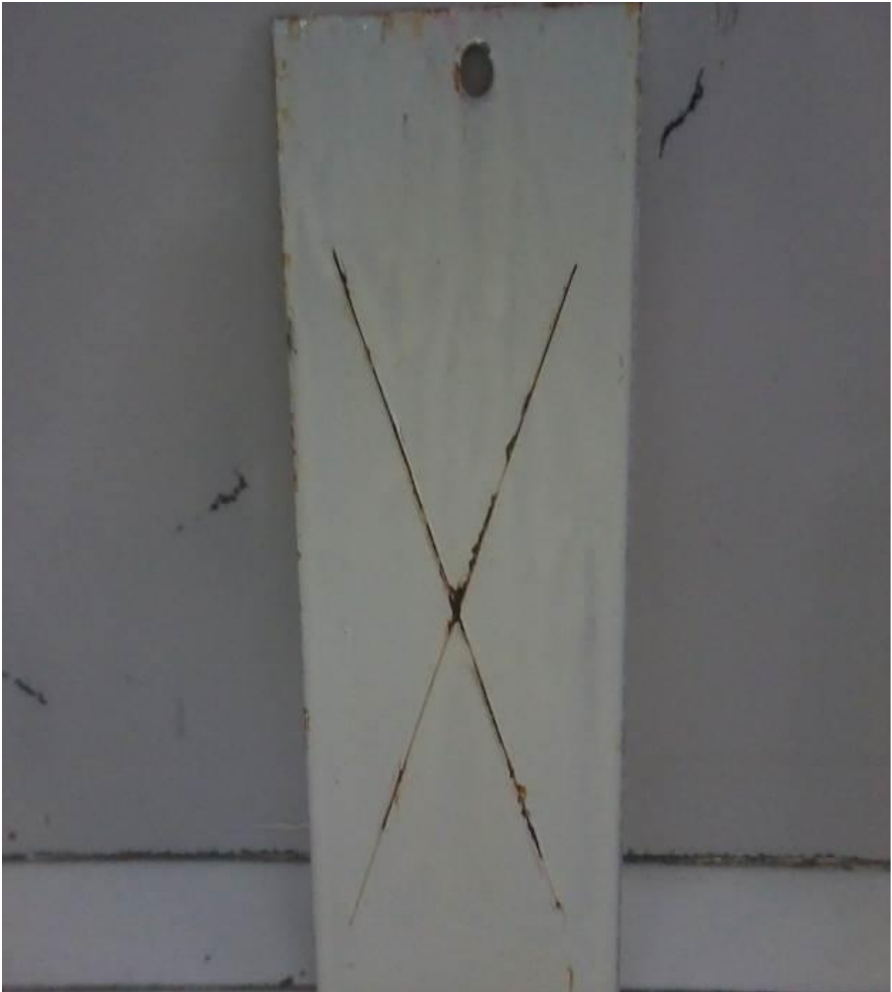
Figure IV. 22 : Test brouillard salin, système de peinture monocouche modifié, épaisseur film sec 100 \mu\text{m} , durée d'exposition 20 jours.
