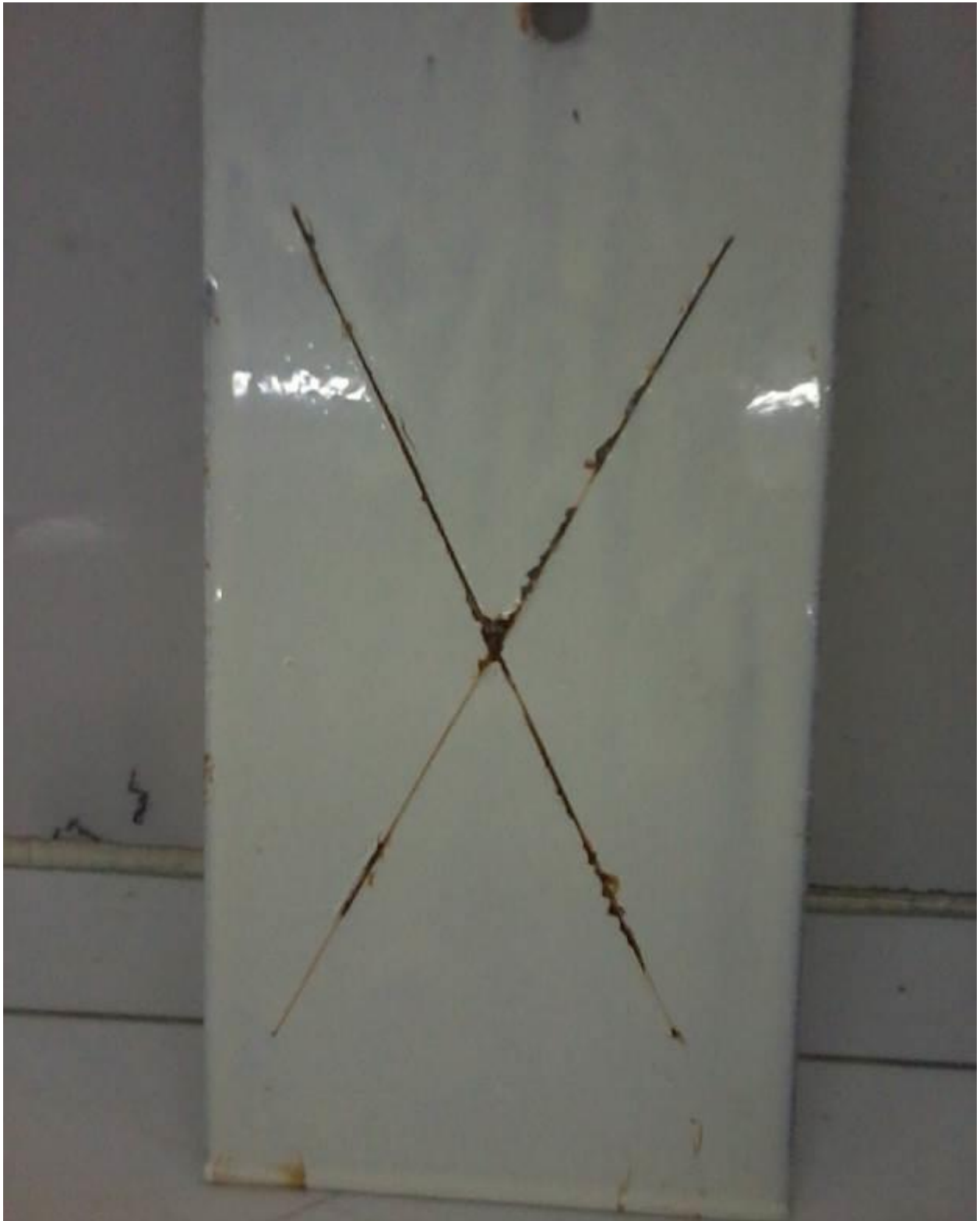
Figure IV. 19 : Test brouillard salin, système de peinture monocouche modifié, épaisseurs film sec 100 \mu\text{m} , durée d'exposition 10 jours.
