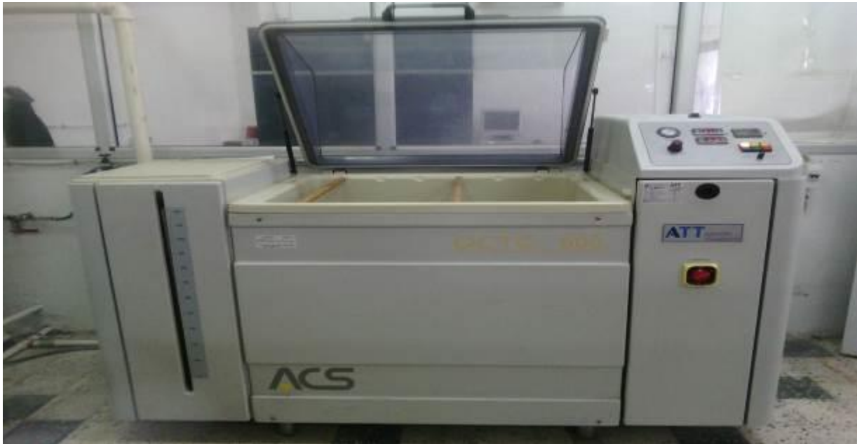
Figure III. 10 : Appareil de test brouillard salin
