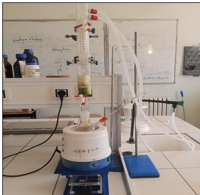
Figure II.2 : Montage expérimental de l'appareil de Soxhlet utilisé pour l'extraction des composés végétaux.
