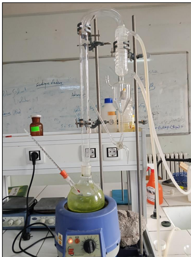
Figure II.3 : Montage expérimental de l'appareil de Clevenger utilisé pour l'extraction des huiles essentielles par hydrodistillation.
