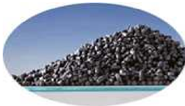
Figure II.10 : Le Charbon Actif Extrude [3].
