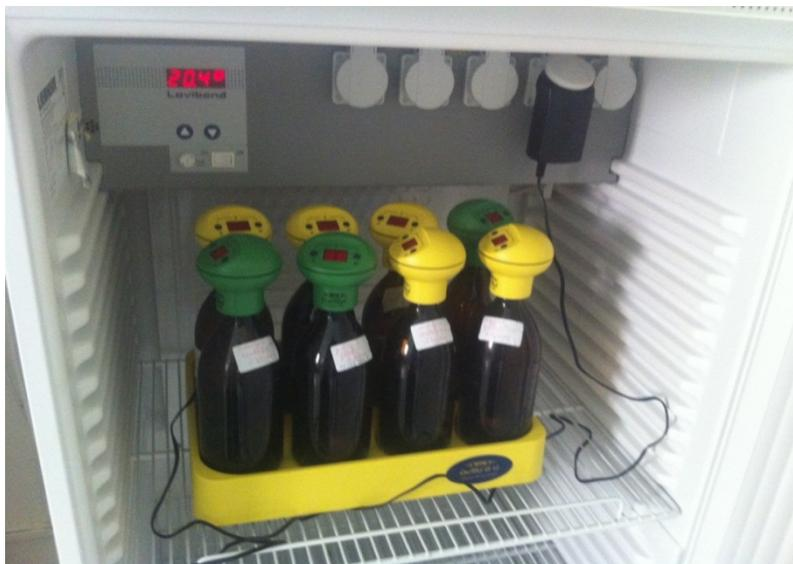
Figure V-4 : Un DBO-mètre
