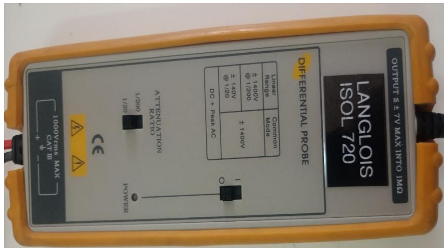
Figure III.6 : capteur de tension LANGLOIS ISOL 720.
