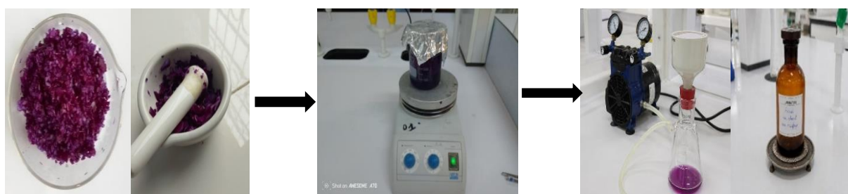
Figure II-2 : Extraction d'anthocyanine par chauffage.
