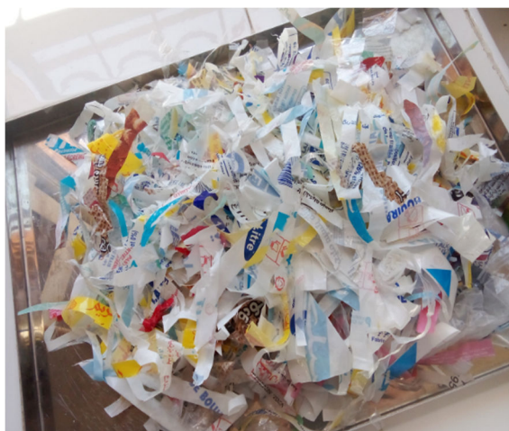
Figure II-2:Plastique de type PE broyé.
