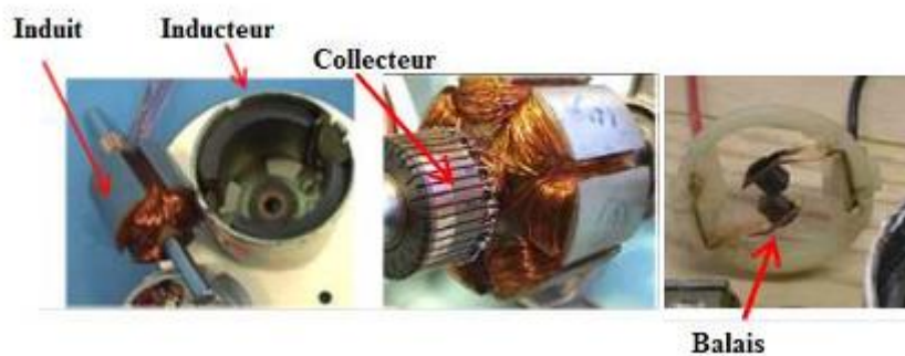
Figure 1.2: Photographie des constitutions d'une MCC.
