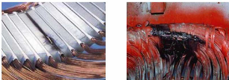
Fig. I.10: Exemples de dégâts dus au défaut de court-circuit statorique d'un moteur
