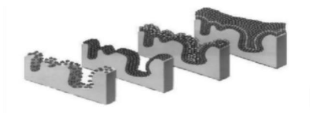
Figure I.7 : Représentation de l'adsorption de l'adsorbat à la surface d'un adsorbant [69].
