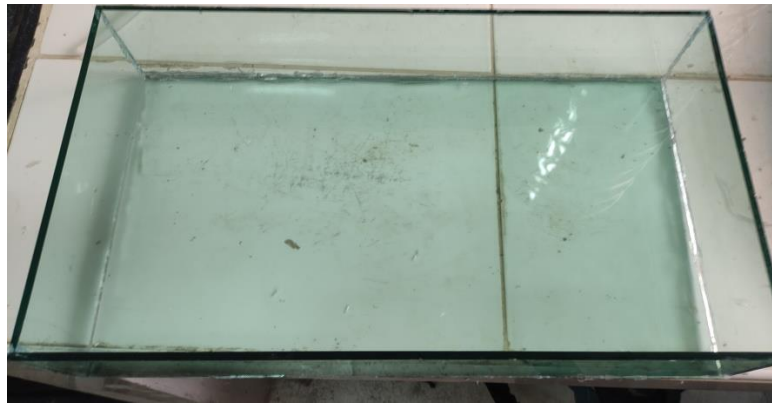
Figure II.4 : moule utilisé pour l'élaboration des plaques
