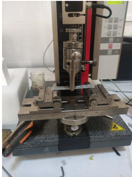
Figure.III.6. Machine de flexion ZwickRoelle.2,5 kN.
