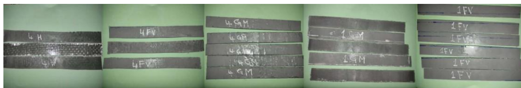
Figure II.9 : Les échantillons d'épreuve en traction conformes à la norme ASTM D3039.
