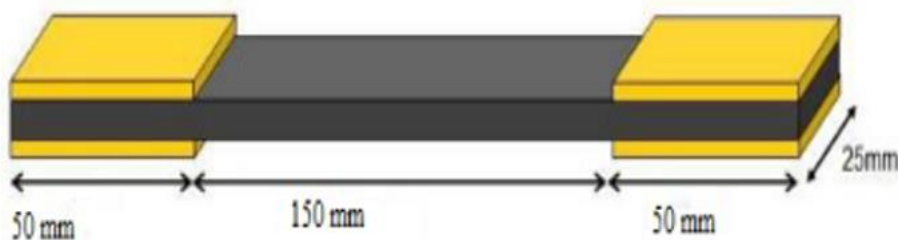
Figure II.8 : La configuration de l'éprouvette utilisée dans les essais de traction.
