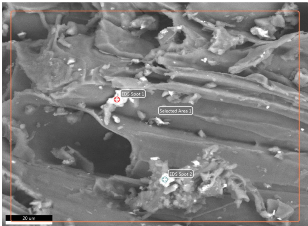
Figure III.27 : Clichés relatifs aux zones de balayage ont été explorées pour étude charbon actif préparé à température de carbonisation T=500^{\circ}\text{C} et sans activation chimique
