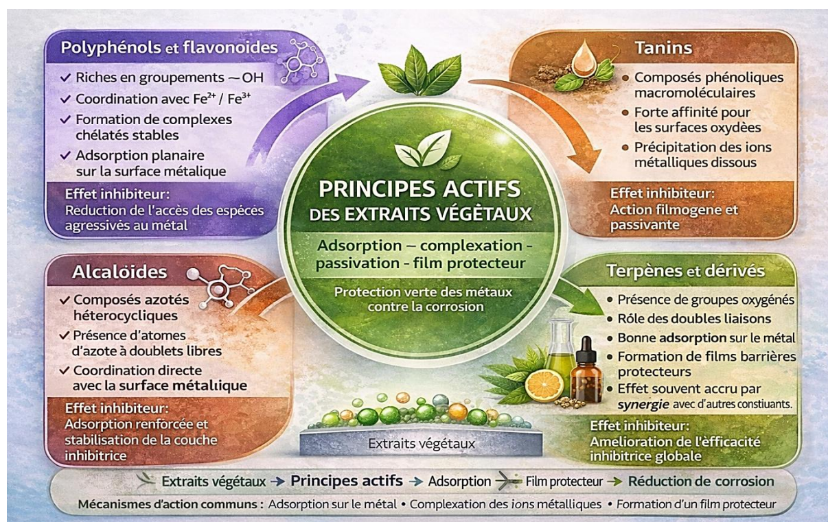
Figure I.16 : Composition phytochimique des extraits végétaux et rôle des principaux principes actifs dans l'inhibition de la corrosion.
