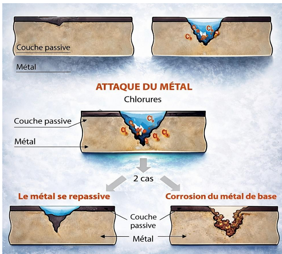
Figure I.5 : Corrosion par crevasse.
