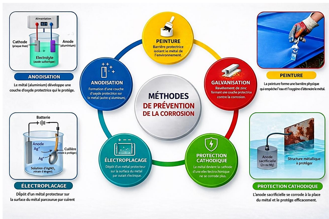
Figure I.10 : Méthodes de prévention de la corrosion.
