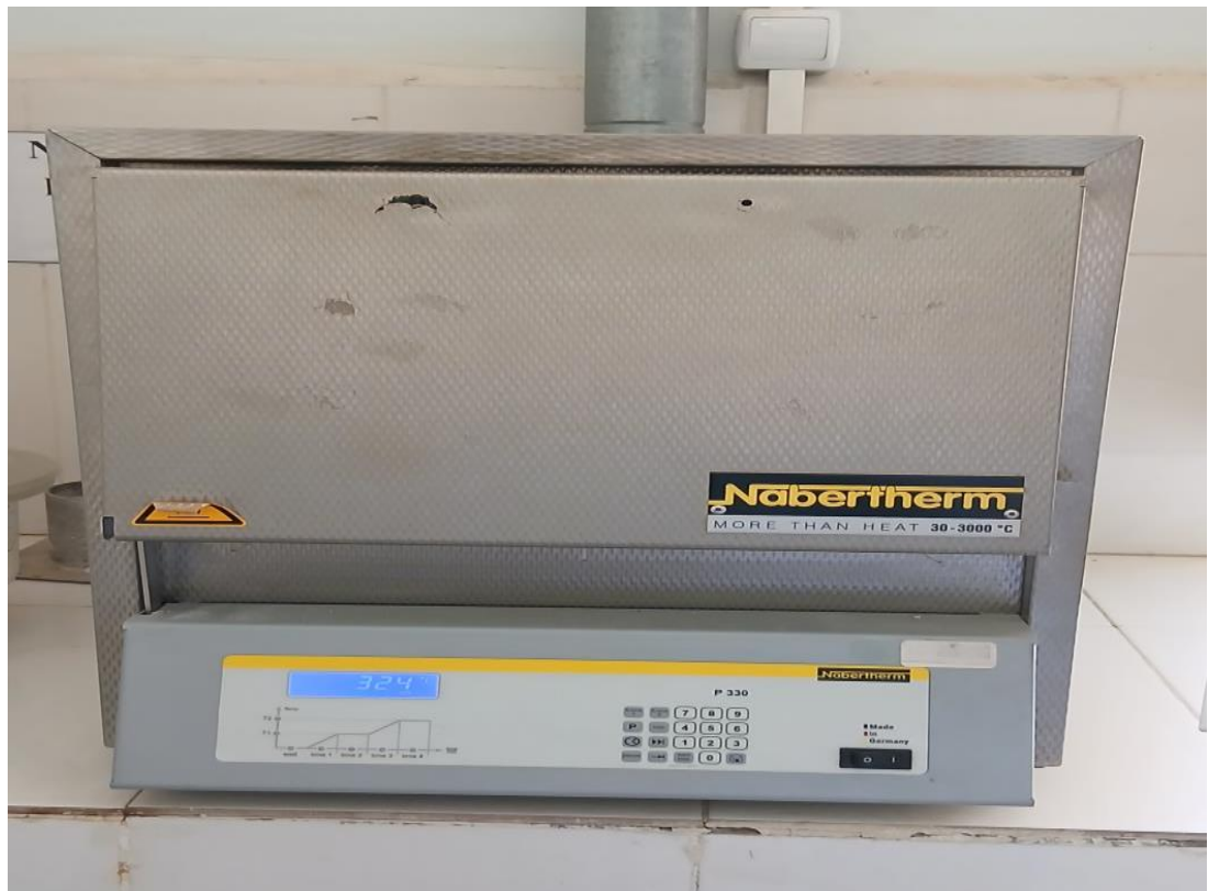
Figure 2.9 : Four utilisé pour le traitement thermique des couches minces de CuO dopé (La–Ce).
