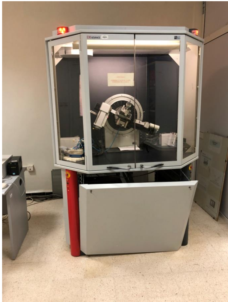
Figure 2.10 : Diffractomètre à rayons X utilisé pour la caractérisation structurale des couches minces de CuO dopé (La–Ce).
