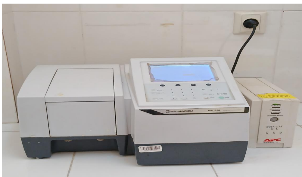
Figure 2.11 : Spectrophotomètre UV-Visible utilisé pour l'étude des propriétés optiques des couches minces.
