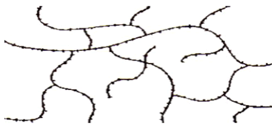
Figure I.4 : Représentation schématique d'un polymère Tridimensionnel [2].
