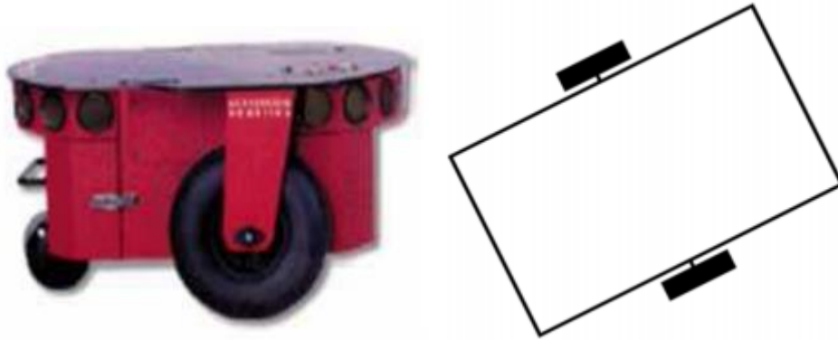
Figure I.3 : robot mobile unicycle « Pioneer P3-DX ».
