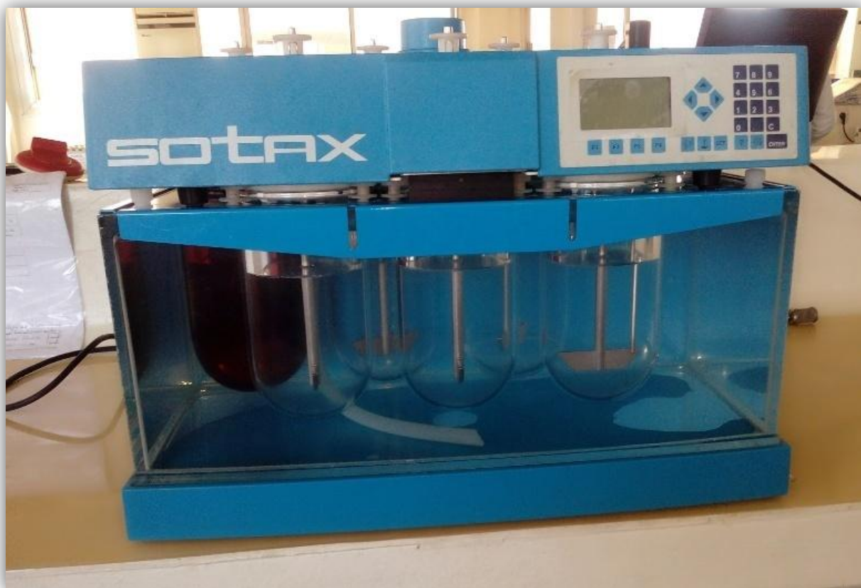
Figure III.5: Photo représentant un dissolu test PHARMATEST (PTUS 300) avec pompe péristaltique.
