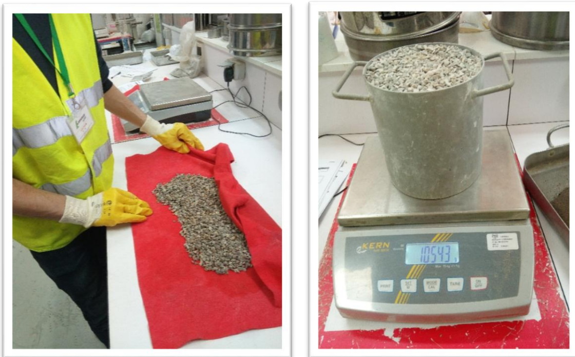
Figure IV.17 : Chiffons absorbant, doux et secs et un Conteneur de 5 L et une Balance.
