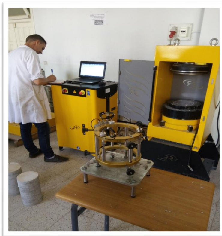
Figure IV.40 : Extensomètre, presse hydraulique et un PC.
