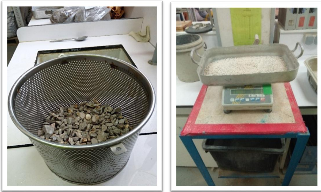
Figure IV.16 : Panier en treillis remplie de gravier 3/8 et une Balance hydrostatique.
