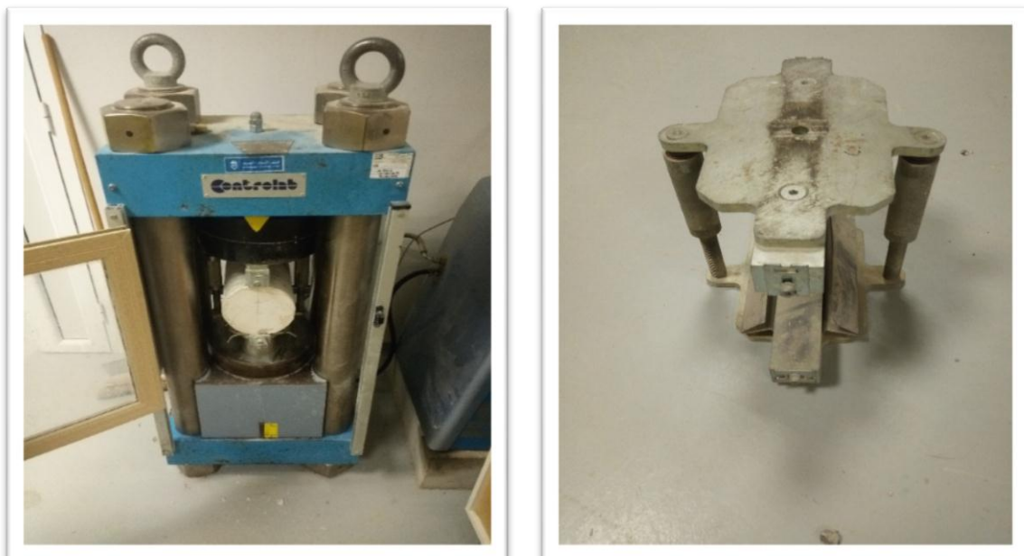
Figure IV.42 : Une éprouvette soumise à l'essai de fendage et un Dispositif de Fendage.
