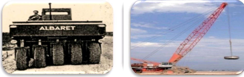
Figure II.1 : Un rouleau compacteur et un Compactage dynamique. [49]
