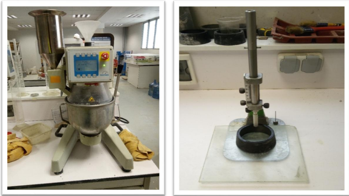
Figure IV.21 : malaxeur normalisé et un Appareil de Vicat muni de sa Sonde de consistance.
