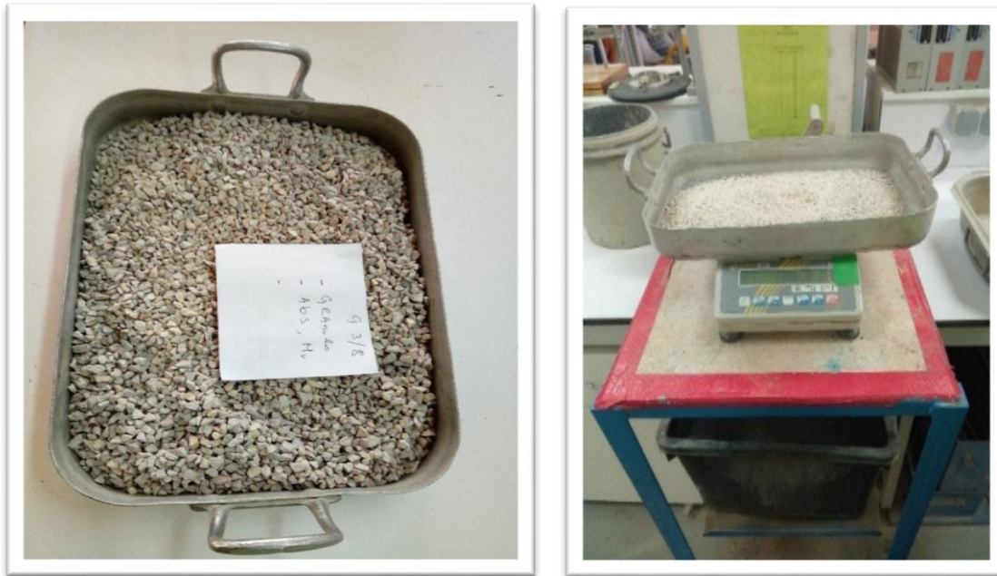
Figure IV.11 : Bac remplie de gravier 3/8 de Kef Azrou et une Balance de pesé.
