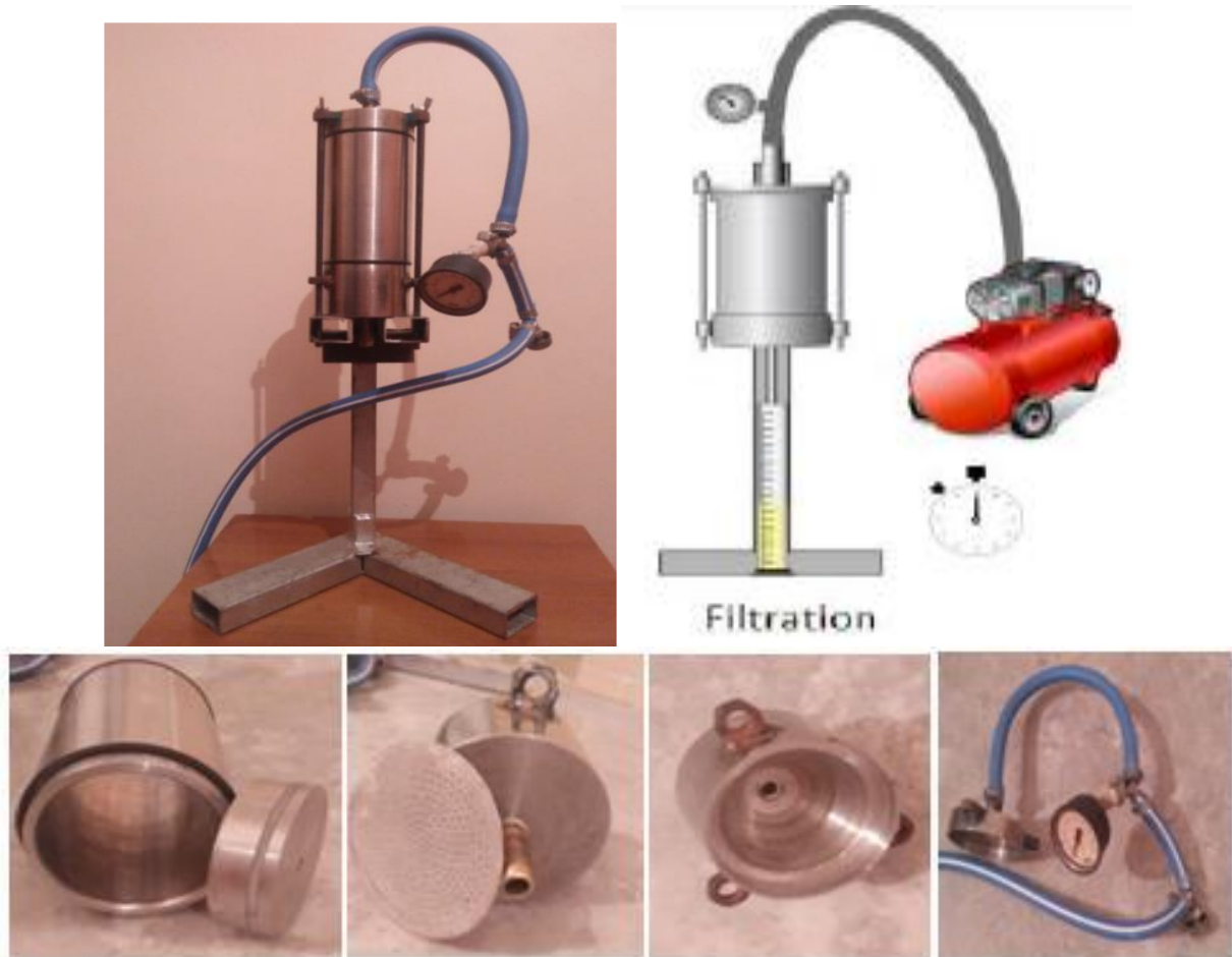
Figure II. 9 : Cellule de filtration sous pression
