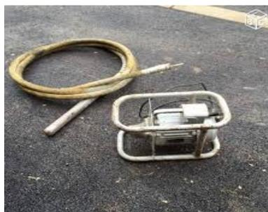
**Figure. I.4.** aiguille Vibration interne
