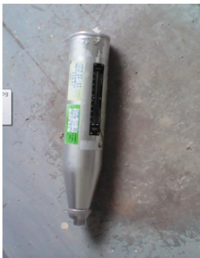
**Figure. I.17.** scléromètre
