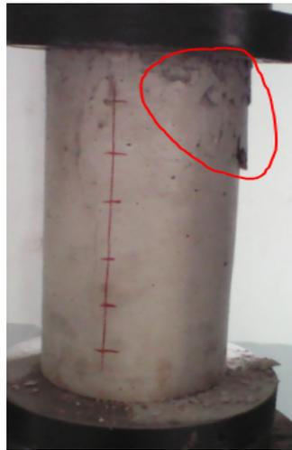
**Figure IV.17.** Mode de rupture d'éprouvette pour  $t > 20s$
