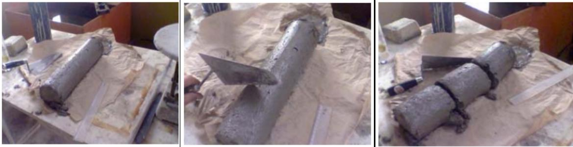
**Figure II.7:** différentes étapes de l'essai de mesure de l'indice de ségrégation statique [16].
