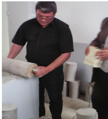
**Figure III.7** : essai aux ultrasons
