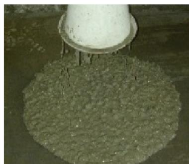
**Figure I.6.** : Essai d'étalement au cône d'Abrams
