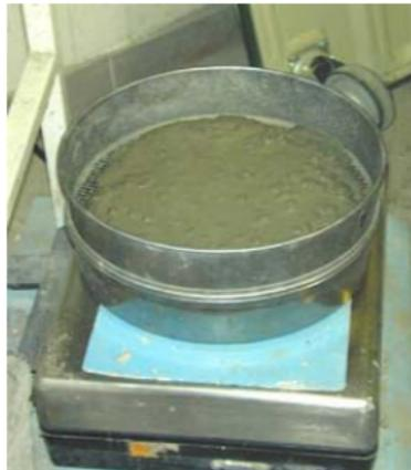
**Figure II.4.** Essai au tamis
