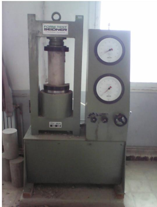
**Figure III.8** : Machine de compression.
