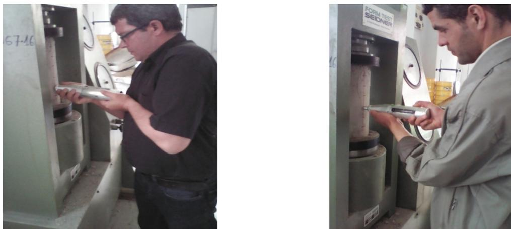
**Figure III.6.** : Essai au scléromètre
