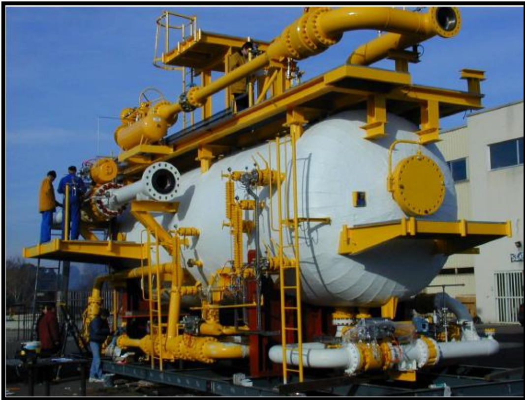
Figure I-9: Vue d'un séparateur triphasique (séparateur de test Girasol) [1]
