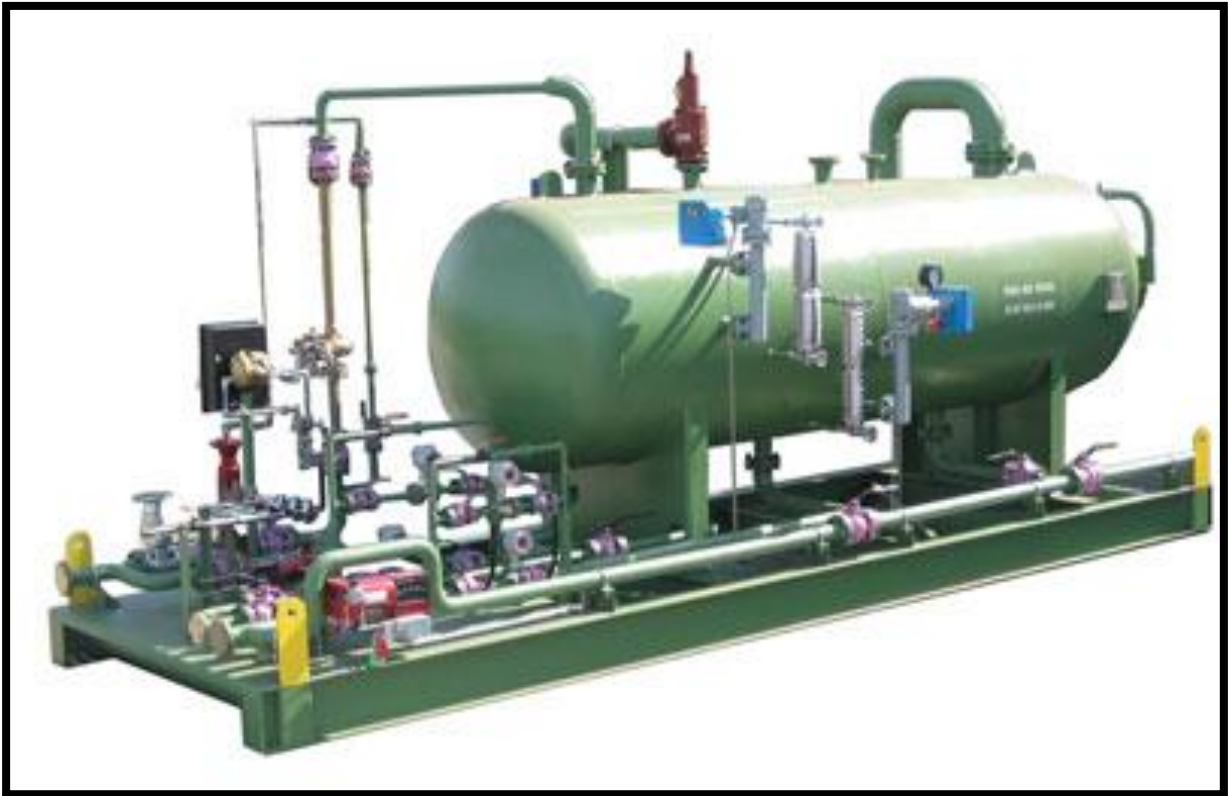
Figure I-2: Exemple d'un séparateur [2]
