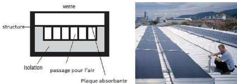
**Figure I.8:** Vue générale d'un capteur à air [15].
