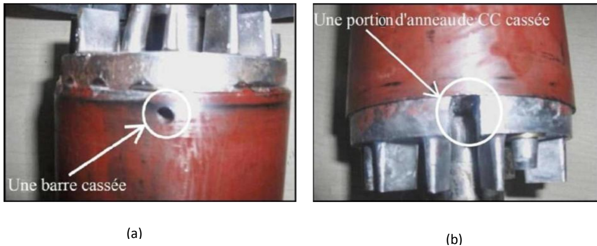
Figure I.9 : Défaut d'un rotor à cage d'écureuil, (a) rupture des barres, (b) rupture d'anneau
