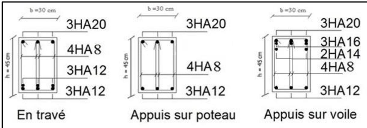
**Figure V.9 : Schéma de ferrailage de la poutre noyé**
