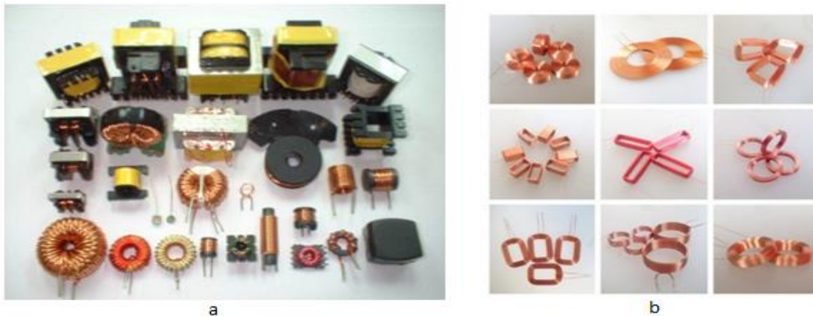
Figure I. 2: a. bobine composées b. bobines simple[.]
