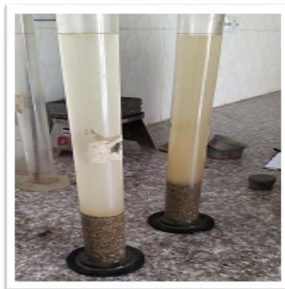
**Figure 3. 3 :** Essai d'équivalent de sable.
