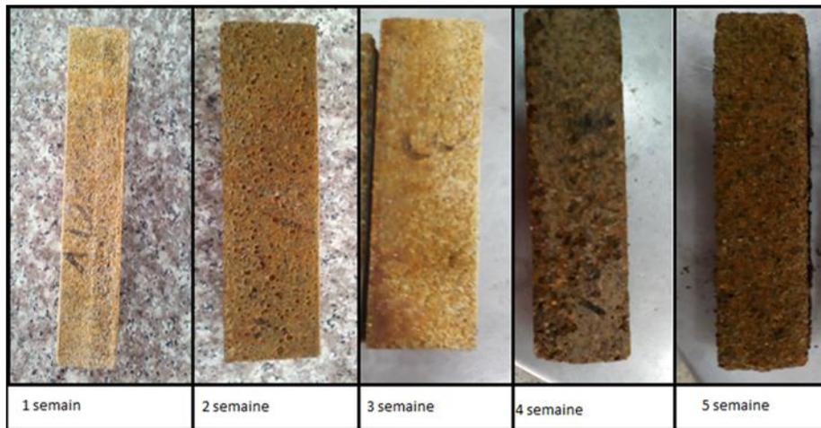
**Figure 4. 16.** Dégradation des échantillons des mortiers autoplaçant MAP20% en fonction de la durée d'immersion dans la solution d'acide chlorhydrique.
