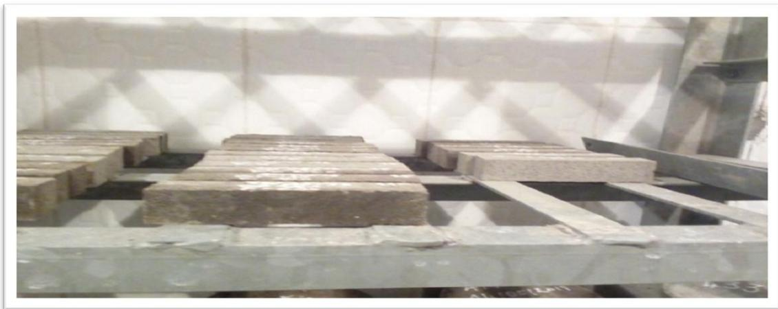
**Figure 3. 7:**Conservation des éprouvettes dans une chambre humide.
