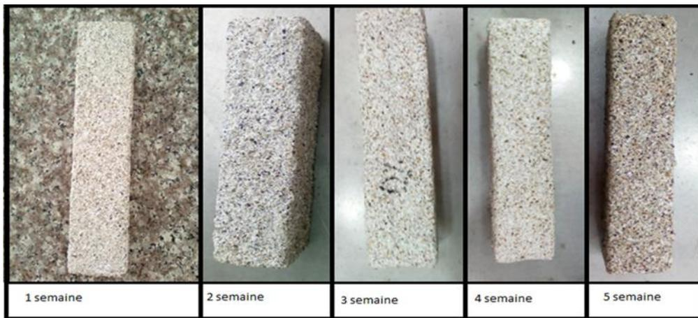
**Figure 4. 17.**Dégradation des échantillons des mortiers témoins en fonction de la durée d'immersion dans la solution d'acide sulfurique.
