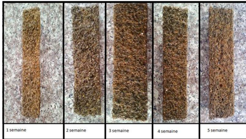
**Figure 4. 14.** Dégradation des échantillons de mortier témoin en fonction de la durée d'immersion dans la solution d'acide chlorhydrique.
