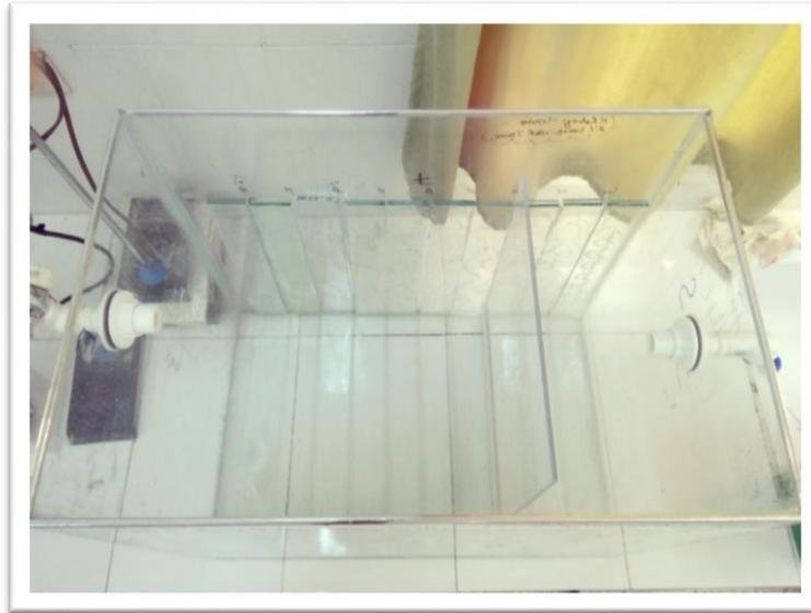
**Figure III.13.** Photo du réacteur à 1 chicane.
