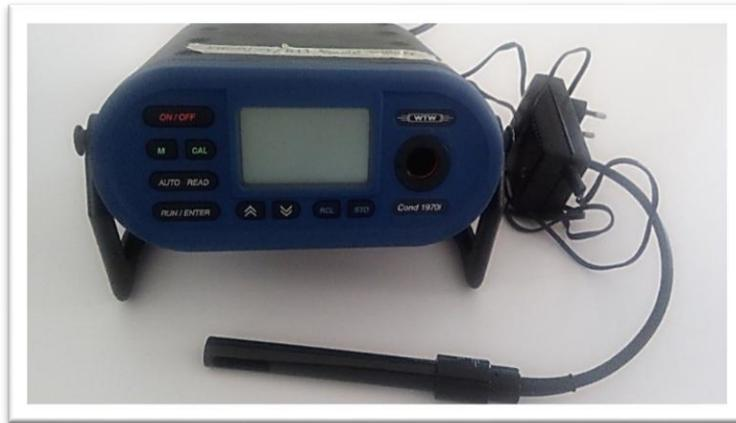
*Figure II.4. Photo d'un conductimètre.*
