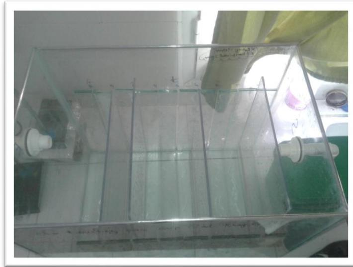
**Figure III.7.** Photo du réacteur à 4 chicanes.
