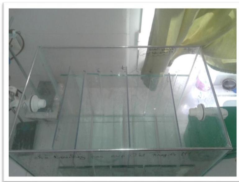
**Figure III.9.** Photo du réacteur à 4 chicanes.
