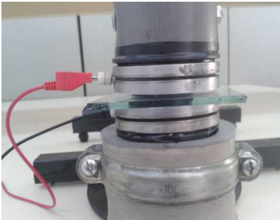
Figure 2.4 : Réacteur de traitement par décharge à barrière diélectrique / Système inter électrode
