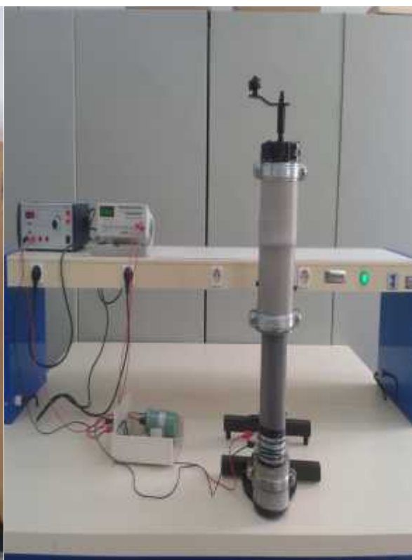
Figure 2.3 : Dispositif de traitement par décharge à barrière diélectrique
