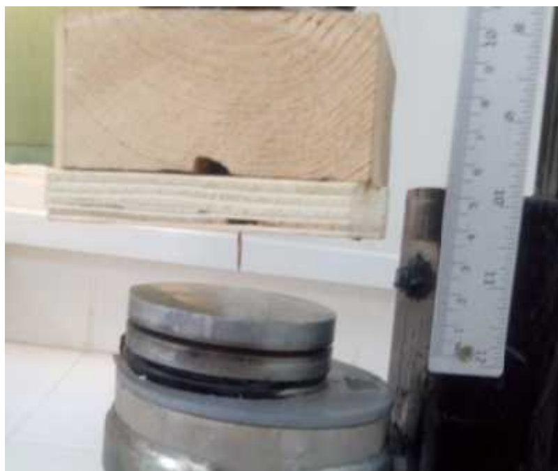
Figure 2.5 : Dispositif de traitement par décharge couronne
