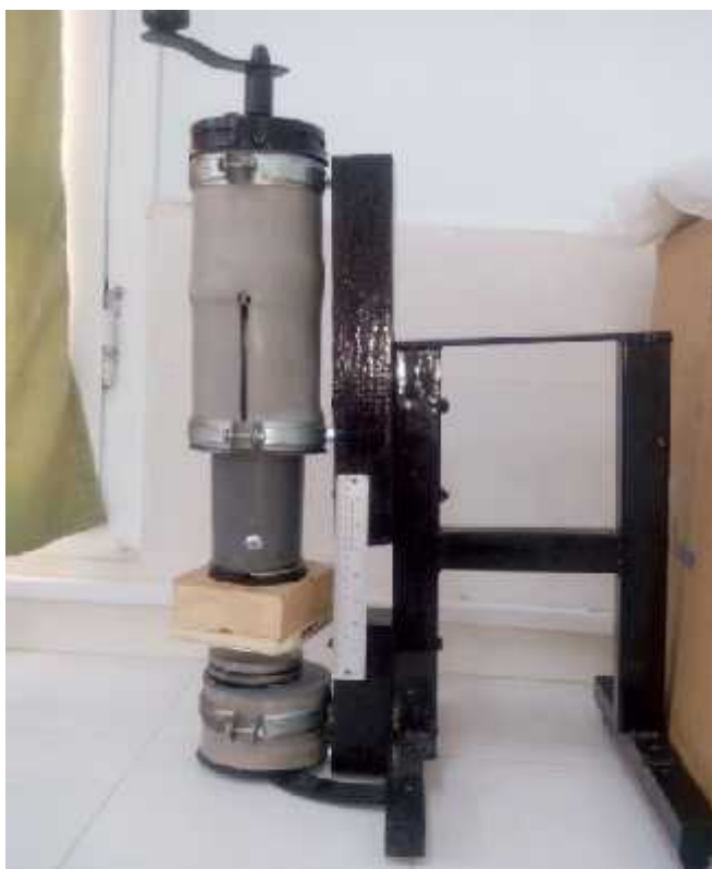
Figure 2.2 : Dispositif de traitement par décharge couronne
