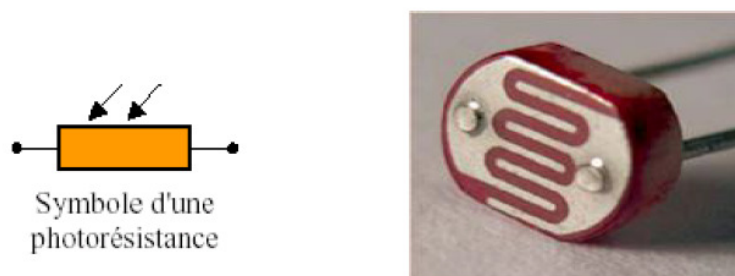
Figure III.14 : Schéma d'un capteur de lumière.
