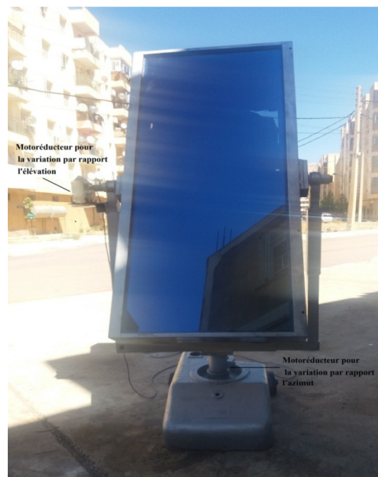
Figure III.3 : Structure mécanique du suiveur solaire.
