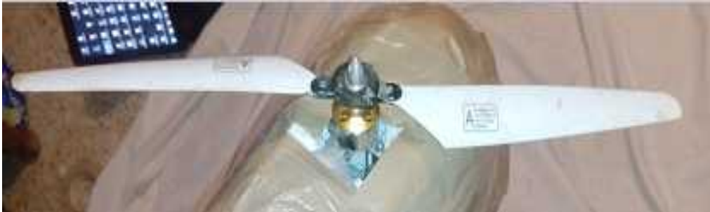
Figure IV.11 : hélice du système d'élévation
