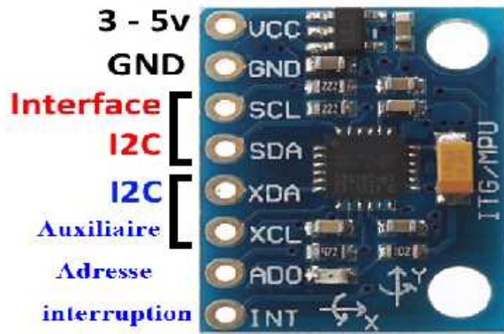
Figure IV.3 : Modèle MPU6050 (accéléromètre et gyroscope)
