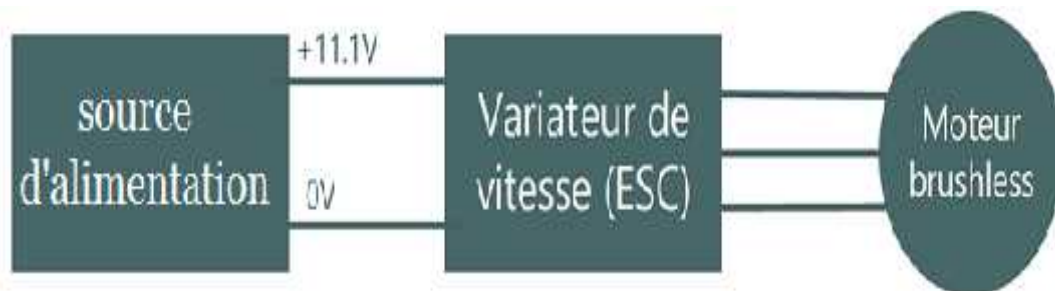
Figure IV.14 :Schéma d'ensemble de la source d'alimentation -Variateur-Moteur
