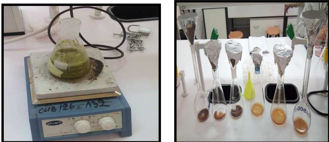
Figure 10 : Agitation et filtration des extraits aqueux
