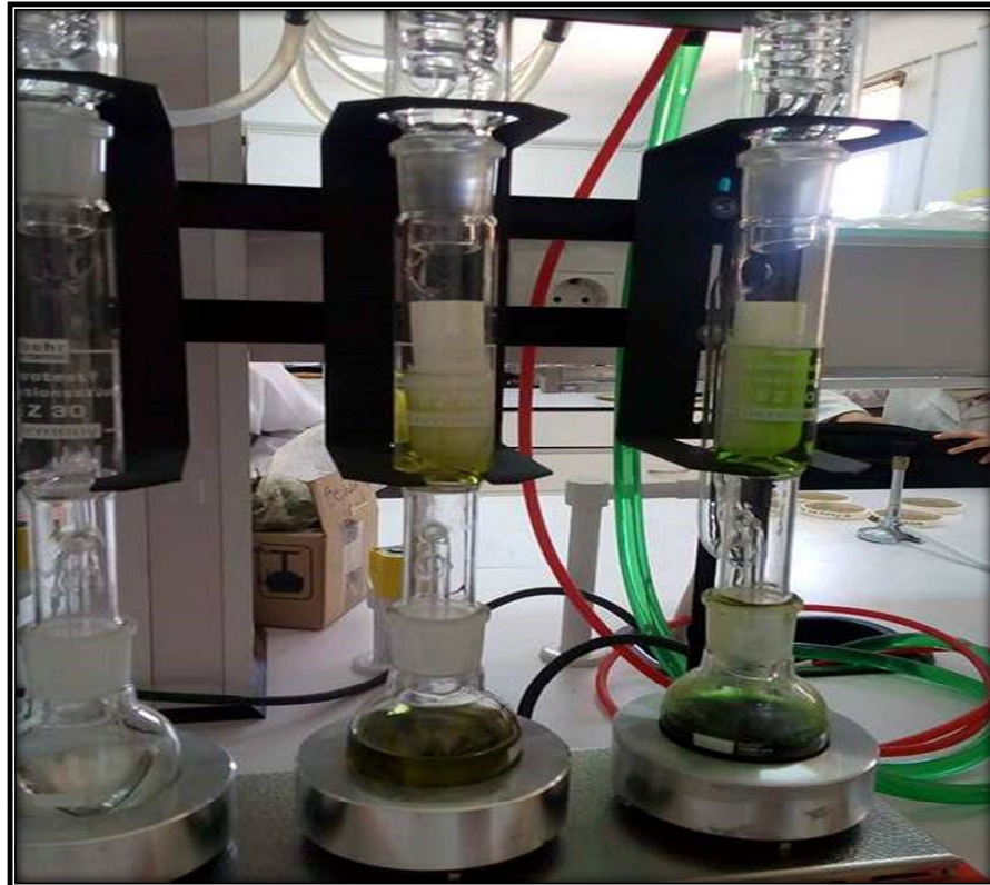
Figure 8 : Appareil du soxhlet lors de l'extraction éthanolique
