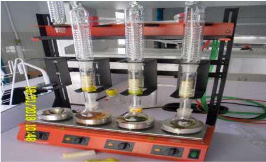
Figure12: l'extraction éthalonique par soxhlet.
