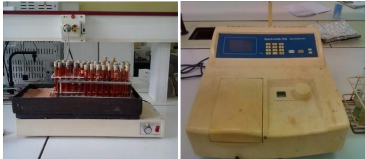
Figure 22 : digestion et dosage au spectrophotomètre du phosphore (Original).
