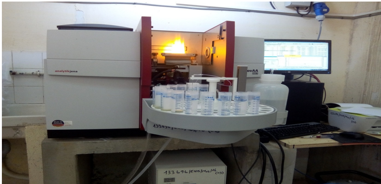
Figure 12 : Spectrophotomètre d'absorption atomique ICE 3000 SERIES AA Spectrometer.
